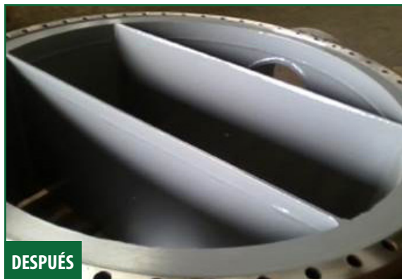
Acero piteado y desgastado reconstruido con Novocoat EP3900 Machinable Paste .
